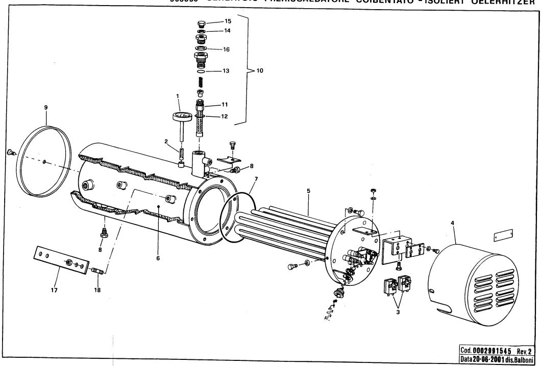
900099 Serbatoio preriscaldatore coibentato
