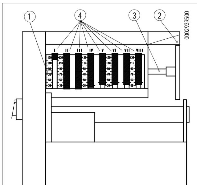
1 Рычаг сцепления и расцепления двигатель-распределительный вал
