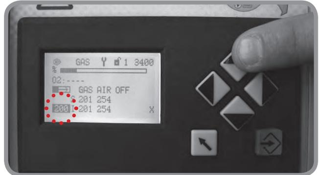
Установить максимальное положение нагрузки 999, в зависимости от выпуска, требуемого котла. Если это необходимо, установить газовое давление входного отверстия (в конце редуктора газового давления). Еще раз проверяйте качественное горение во всех положениях и урегулировать газ и воздух, если необходимо (смотреть страницу 5).
